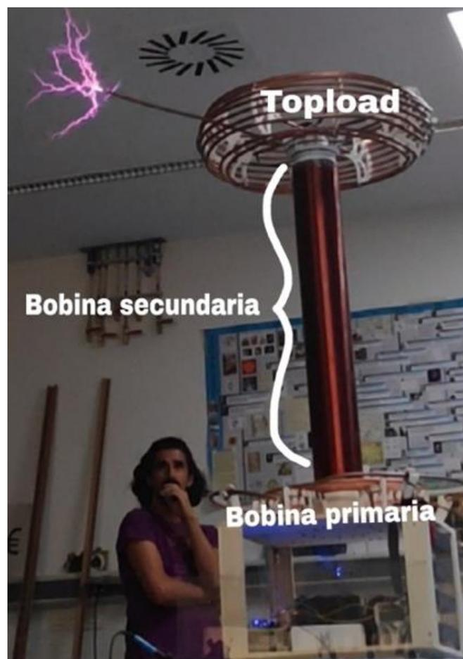
*Partes de una bobina de Tesla: dentro de la estructura de madera se encuentra la electrónica necesaria para que todo funcione. Encima de la madera se encuentra la bobina primaria y a continuación la secundaria y el "topload".*
